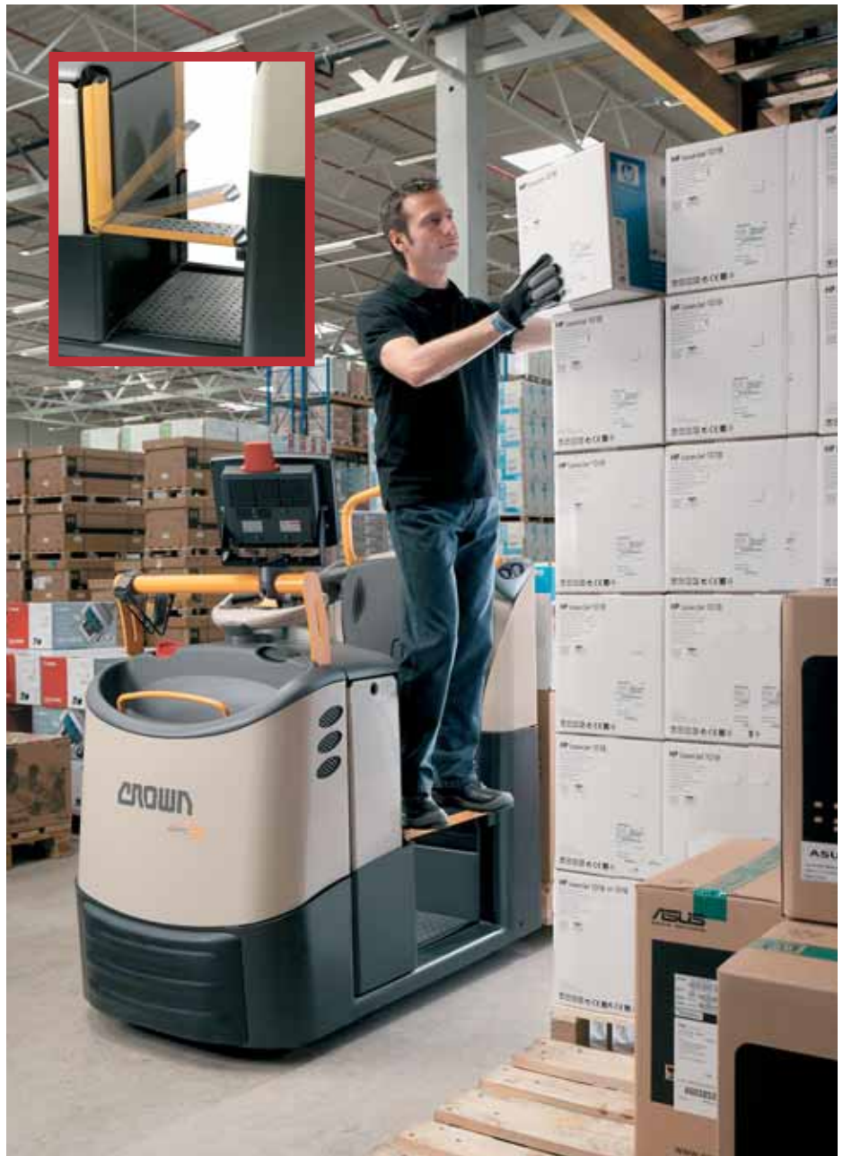
CROWN GPC 3040 a lehajtható lépcsőfokkal segíti a két méter magasan tárolt áruk elérését
